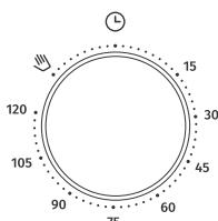
**ТАЙМЕР ОТКЛЮЧЕНИЯ** (реле времени). Сначала установите режим и температуру приготовления. Установите время таймера, вращая переключатель таймера по часовой стрелке. По истечении установленного времени выбранный режим нагрева отключается.
